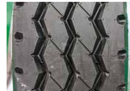
Так выглядит рисунок протектора ЦМК-шин, идущих на прицеп...
