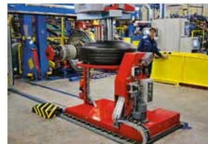
На таком устройстве покрывку снимают со сборочного барабана
