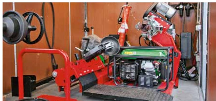
Чтобы обеспечить полную автономность шиномонтажной мастерской, ее комплектуют мощным генератором с приводом от бензинового или дизельного двигателя
