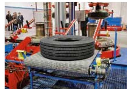
Готовая шина охлаждается на специальном конвейере
