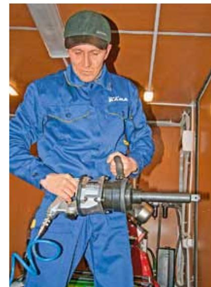
Открутить прикипевшие гайки колес поможет мощный пневмогайковерт
