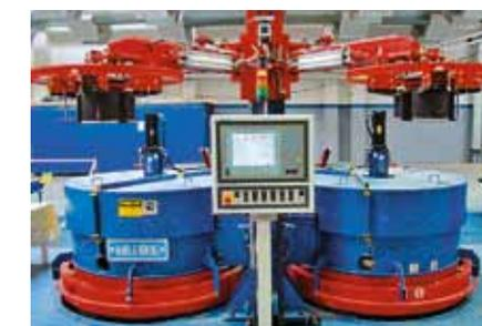
Гидравлический пресс 62/1000 производства фирмы McNeil&NRM
