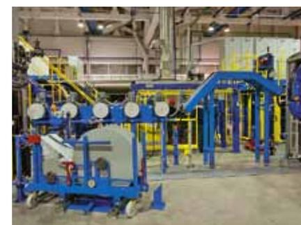
Автоматическая линия TDA для изготовления бортовых колец
